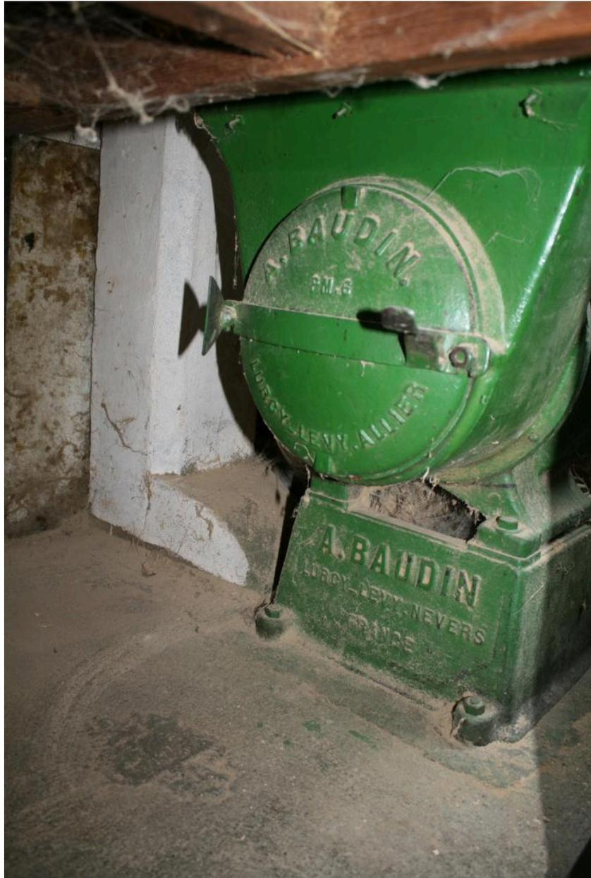
Base du bâti et logement du volant d'entraînement de la bande abrasive portant le nom du fabricant et le lieu de fabrication.
