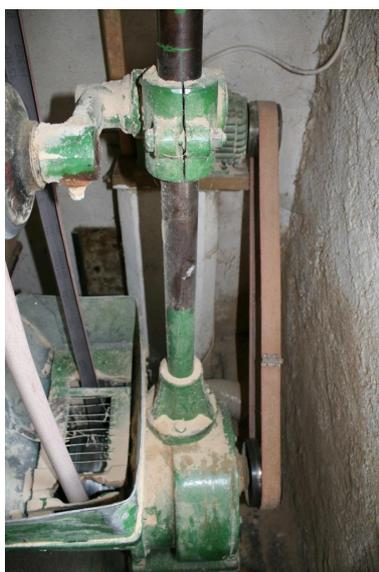
Détail : courroie d'entraînement à droite et bande abrasive à gauche.
