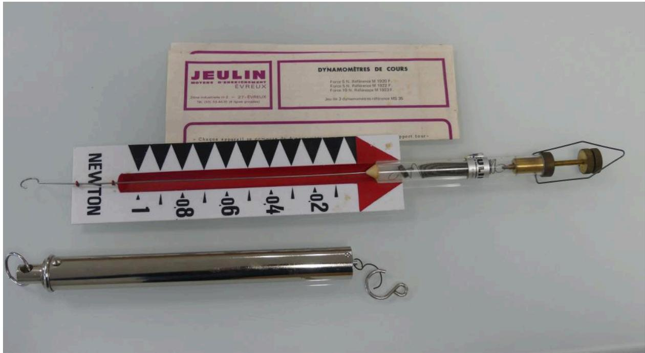
Vue générale d'un dynamomètre.
