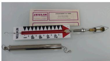
Vue générale d'un dynamomètre.
